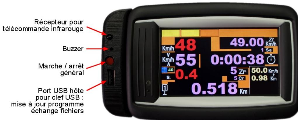
**Important** : le boîtier plastique fabriqué par impression 3D **ne résiste pas à la température que l'on peut trouver dans une auto fermée, sous un pare-brise, au soleil de l'été**. De ce fait, si votre auto doit rester stationnée au soleil, nous vous conseillons :
