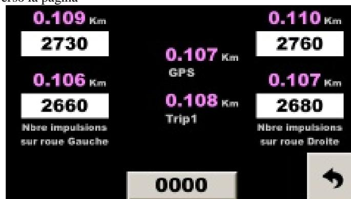
Questa pagina consente di confrontare tutti i "sensori" delle ruote e la distanza calcolata per ciascuna ruota, la distanza GPS calcolata e il Trip1, a seconda della configurazione e delle distanze di ciascuna ruota.
