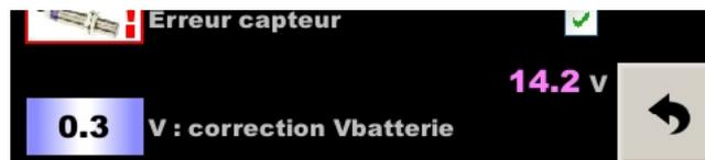
In alcune vetture, ci possono essere alcuni decimi di volts di differenza tra la tensione visualizzata e la tensione effettiva. Questa correzione li può compensare. Il valore letto viene visualizzato a destra e deve essere confrontato con un voltmetro collegato alla batteria.
