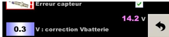
Dans certaines voitures, il peut y avoir quelques dixièmes de volts d'écart entre la tension affichée et la tension réelle. Ce paramètre permet de les compenser. La valeur lue est affichée sur la droite et doit être comparée avec un voltmètre branché sur la batterie.
