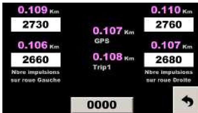
Cette page permet de comparer tous les "capteurs" de roue, la distance calculée pour chaque roue, la distance GPS calculée et le Trip1, en fonction de la configuration et des distances de chaque roue
