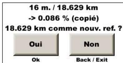
Il a donc une idée précise de l'ajustement d'étalonnage nécessaire, en mètre / Km et en pourcentage. Le **pourcentage est mémorisé par l'appareil pour être utilisé dans la page d'ajustement fin de l'étalonnage** (voir plus loin). La référence de distance est le point de départ du cumul des corrections. En général la remise à 0 au départ d'une ZR. Le calcul de pourcentage est fait à partir de ce point, **jusqu'à la distance de la dernière correction**. Le copilote a alors deux options :
