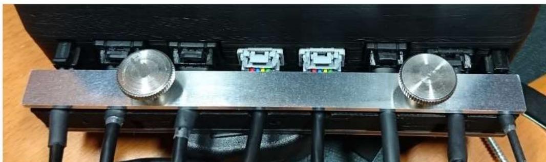
**Led6 Afficheur pilote Alim. Capteur gauche Capteur Droit Boîte à boutons GPS Répéteur audio**
