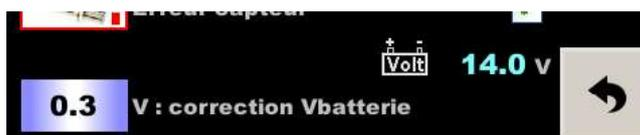
Dans certaines voitures, il peut y avoir quelques dixièmes de volts d'écart entre la tension affichée et la tension réelle. Ce paramètre permet de les compenser. La valeur **lue et corrigée** est affichée sur la droite (**ici 14.0 V**) et doit être comparée avec un voltmètre branché sur la batterie.
