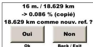
Il a donc une idée précise de l'ajustement d'étalonnage nécessaire, en mètre / Km et en pourcentage. Le **pourcentage est mémorisé par l'appareil pour être utilisé dans la page d'ajustement fin de l'étalonnage** (voir plus loin). La référence de distance est le point de départ du cumul des corrections. En général la remise à 0 au
