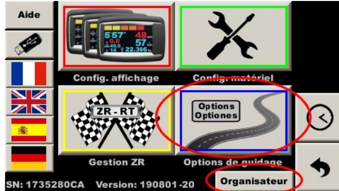
Puis la fonction de recalage GPS doit être activée dans la page des options de guidage (en bas) du menu principal par la case à cocher « Correc. dist. par GPS ». Si cette case n'est pas présente, l'option n'a pas été validée, nous contacter.
