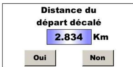
Il est possible de modifier cette distance en appuyant sur la valeur, tapant une nouvelle valeur puis appuyant sur **Oui**. Si on ne veut pas la modifier (simplement fermer la popup), il suffit d'appuyer sur **Non**.
