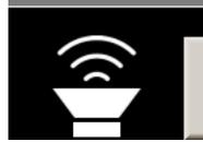
Le **buzzer sonne lorsque le capteur est actif**. Cela permet d'aider au réglage des capteurs qui n'ont pas de voyant. Si l'atelier est calme, même sous la voiture, on doit entendre le buzzer lorsqu'on approche le capteur de l'aimant ou de son plot.
